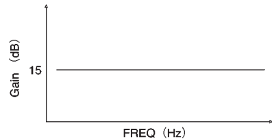
Fig. 8 Total frequency characteristics when ALS is off
